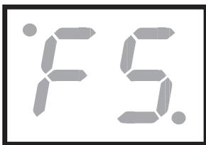
Codul de avarie F5 poate să apară în cazul defectării senzorului de temperatură exterioară (dacă
