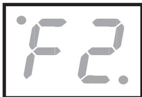
Codul de avarie F2 este afișat în cazul în care senzorul de temperatură AT din cazan se defectează, sau temperatura AT
